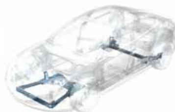
El chasis conforma la parte inferior de la estructura del vehículo e incluye sistemas, bastidores y piezas relacionadas, como los ejes y acoplamientos frontales y traseros, brazos de control y acoplamientos integrados, que conectan la carrocería y la transmisión de un automóvil, y soportan el peso del vehículo. Estas estructuras son esenciales para la dinámica, el rendimiento y la seguridad del vehículo e influyen particularmente en el ruido, la vibración, la conducción y los impactos.
